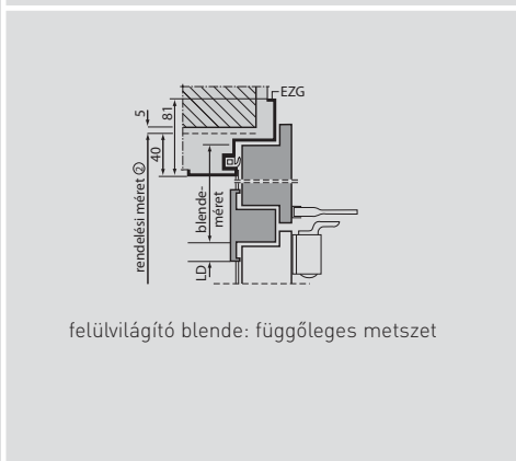
felülvilágító blende: függőleges metszet
